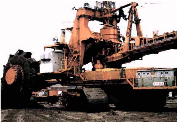
写真-4 常陸那珂港北埠頭埋立工事のBWE
